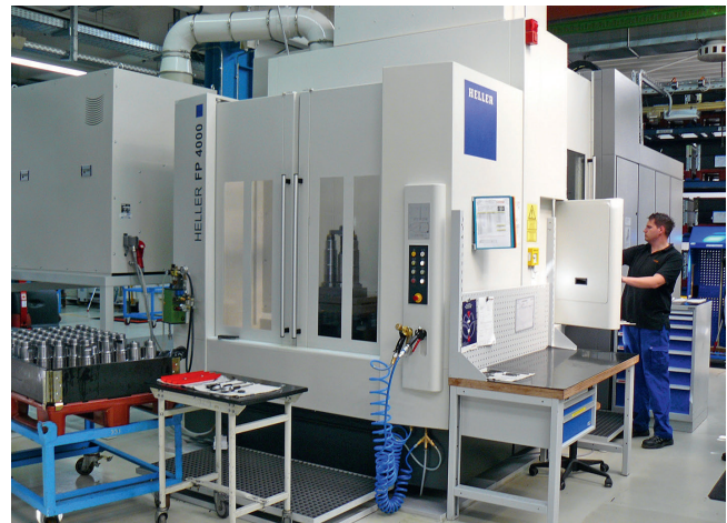
3 Mit dem 5-Achs-Bearbeitungszentrum FP 4000 konnte ein Kunde die Fertigungsschritte für ein Gehäuse von fünf auf nur einen reduzieren © Heller
